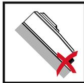
Le Wattpilot ne doit pas être monté sur une surface inclinée avec le connecteur vers le bas.
