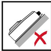
Ne pas monter le Wattpilot sur une surface inclinée.
